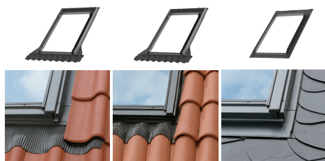
Профил. кров. материал. Высота волны до 45 мм Профил. кров. материал. Высота волны до 120 мм Плоский кров. материал. Толщина мат-ла до 16 мм (2x8)
